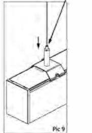
9. Joindre le filin à la patte de fixation. Appuyez sur le bouton ressort du manchon, insérez le filin et ajustez la longueur.
