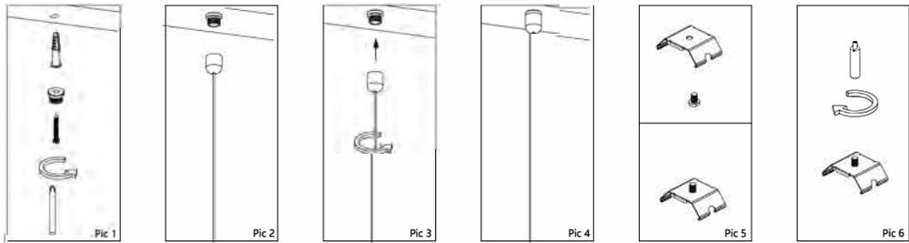
1. Percez un trou au plafond et insérez la cheville en plastique. Placez la vis cruciforme dans la rondelle de fixation, puis dans la cheville, comme indiqué sur le schéma.
