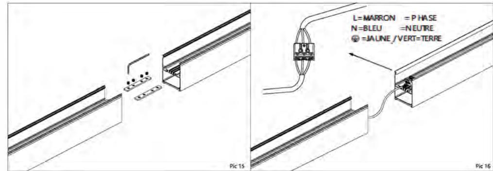
15. Connectez les barres entre elles avec les barrettes de jonctions, assurez-vous que la jointure soit inapparente et serrez les vis M6.
